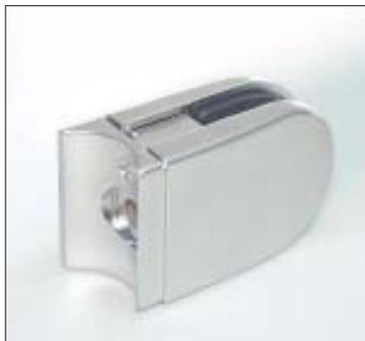
Das **ovale Anschraubloch** in Verbindung mit dem Ausrichtplättchen ermöglicht eine **spannungsfreie Glasmontage** auch bei leicht versetzten Anschraubbohrungen.
