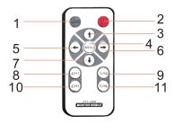
1.Mode 2.Power 3.Up 4.Menu 5.Left 6.Right 7.Down 8.CH1 9.CH2 10.CH3 11.CH4
