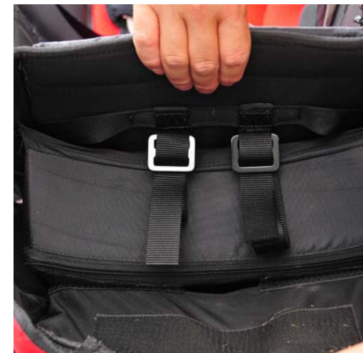
Verstellung der Beinschlaufen unter dem Sitz
