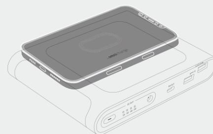
注：最適な充電範囲は、携帯電話の受信コイルのサイズによって異なります。一部の電話モデルには小さな受信機コイルがあり、数秒間充電すると突然中断することがあります。これは、送信機と受信機のコイル間のわずかな位置合わせのずれによるものです。電話を持ち上げ、数秒待ってから、安定したワイヤレス充電が得られるまで位置を微調整してください。
