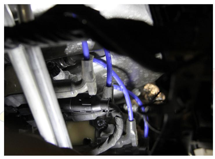
**STEP SEVEN:** DISCONNECT SPARK PLUG WIRES
