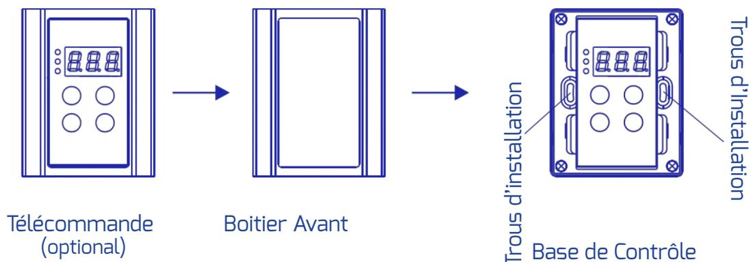
2. Sur le site d'installation, marquez et vissez deux trous avec 0,24 "à 1,2" de profondeur. Insérez 2 vis en caoutchouc dans les trous. Placez la télécommande contre le mur, alignez les trous de contrôle avec les trous dans le mur, et les fixer avec des vis de bois. (Voir l'illustration ci-dessous)
