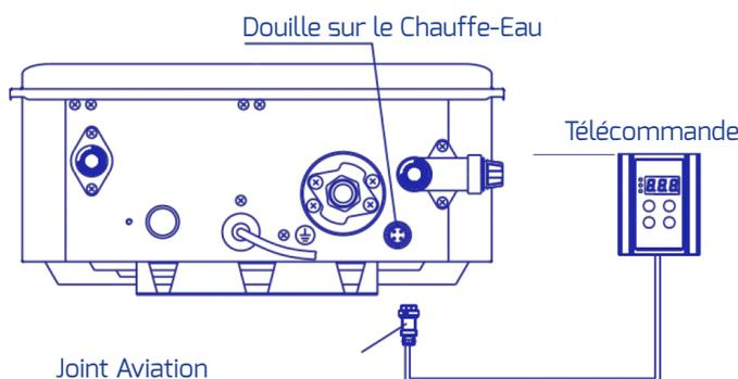
2. Pour deux contrôles: d'abord, enlever les joints de l'aviation sur les deux contrôleurs, branchez une dans la prise sur le chauffe-eau (la longueur dépend de vos besoins), et jeter l'autre. Puis connecter les fils de l'articulation de l'aviation au fil d'entrée du connecteur, et relier les deux contrôleurs sur les fils de sortie du connecteur.
