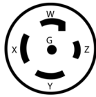
NEMA L23-30P NEMA L23-30R 30 Amps 347/600 Volts
