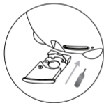
Fig. 3 Compartimento per la Batteria
