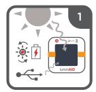
Cárguela directamente al sol durante 10 horas o con el micro-USB en 1-2 horas. El LED rojo indica que la batería está cargándose.
