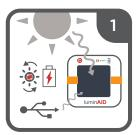
Lade den Akku draußen in direkter Sonne für 10 Stunden, Lade das Mikro-USB-Eingang für 1-2 Stunden. Rote LED zeigt an. dass der Akku geladen ist.
