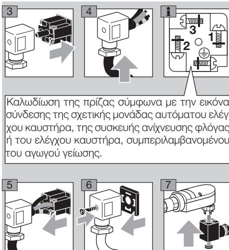
Καλωδίωση της πιρίζας σύμφωνα με την εικόνα σύνδεσης της σχετικής μονάδας αυτόματου ελέγχου καυστήρα, της συσκευής ανίχνευσης φλόγας ή του ελέγχου καυστήρα, συμπεριλαμβανομένου του αγωγού γείωσης.
