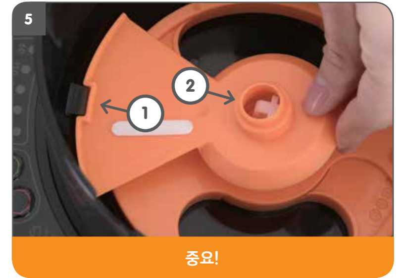
중요! 1 휠 잠금 덮개의 홈을 분유통 안쪽 돌출부에 맞춥니다. 2 홈과 돌출부가 잘 맞았으면, 휠 잠금 덮개를 본체 축에 끼워 넣습니다.
