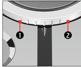
**Ejemplo:** así se modifica el grado de molido durante la preparación de un Espresso.
