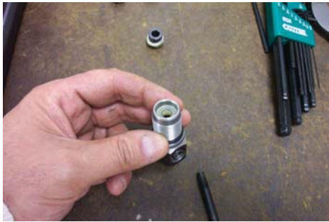
34. View of wrist pin anchor (Item 13a) showing upper cup seal (Item 15) and nylon back up washer (Item 14). 34. Ansicht des Handgelenkstiftes Anker (Einzelteil 13a) obere Schale Dichtung (Einzelteil 15) und Nylonstützscheibe (Einzelteil 14) zeigend.
