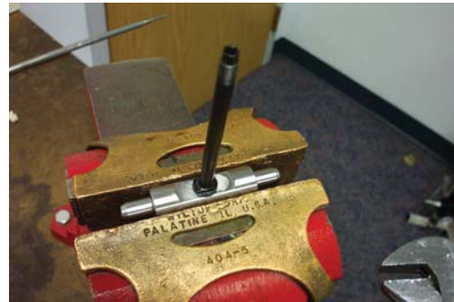
37. Hold outlet pin (Item 8) and plunger tube (Item 10) in vise. 37. Halten Sie Anschlußstift (Einzelteil 8) und Spulenkernschlauch (Einzelteil 10) im Kolben.
