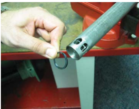
15. Remove spiral retaining ring (item 59) from housing tube. 15 Entfernen Sie Seegerring der Spirale (Einzelteil 59) vom Gehäuseschlauch.
