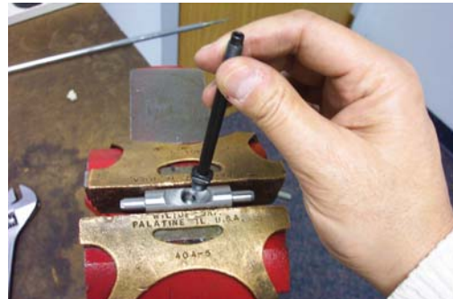
39. Remove plunger tube (Item 10). (Ressembly recommendations; replace o-ring (item 9). use Loctite 242 or equivalent on plunger tube threads.) 39. Entfernen Sie Spulenkernschlauch (Einzelteil 10). (Ressembly Empfehlungen; ersetzen Sie O-Ring (Einzelteil 9). verwenden Sie Loctite 242 oder Äquivalent auf Spulenkernschlauchgewinden.)
