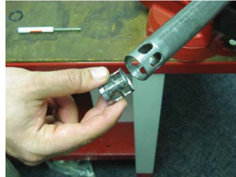
16. Remove shovel plug (Item 58) and spacer (Item 56b©) from housing tube. 16. Entfernen Sie Schaufelstecker (Einzelteil 58) und Eingang Schirm (Einzelteil 56b©) vom Gehäuseschlauch.
