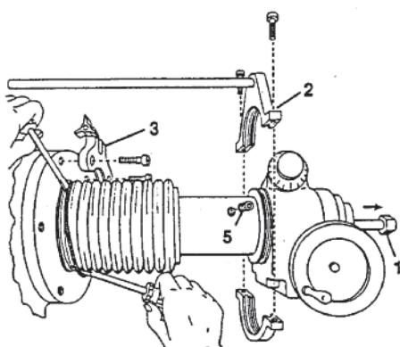
Use un automil-lador para estirar el cargador termoplástico sobre el anillo del adaptador.
