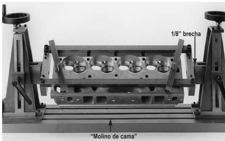
Es necesario aplicar presión firmemente para asegurar la cabeza en la posición firme e ideal. La cabeza debe ser colocada inicialmente en posición paralela en relación al soporte inferior principal durante el montaje inicial. En este punto deben quedar espacios en ambos lados de  $1/8"$  (revise anterior).
