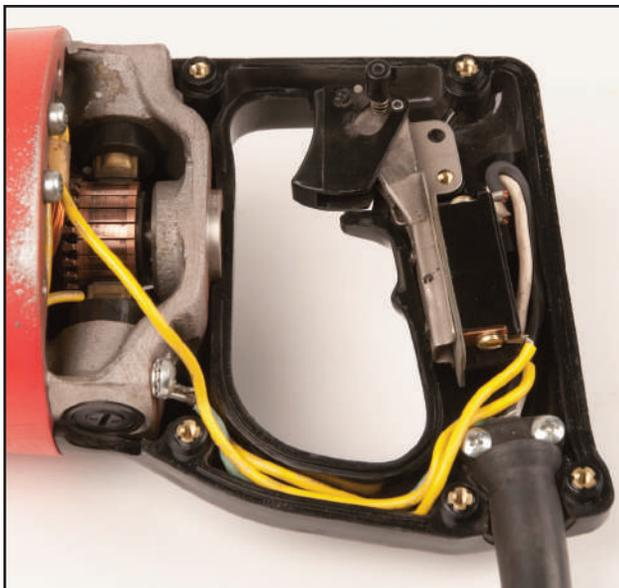
2. Retirar los tornillos de montar para liberar el gatillo de la palanca.
