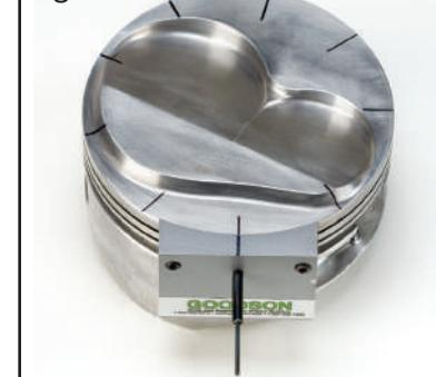
Aviso: Taladrando el puerto de gas más profundo que la ranura de anillo puede destruir el pistón por taladrando por el pistón de válvulas de relieves o adentro del pistón.
