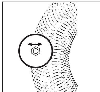
4. Trabaje la herramienta en movimientos de adentro hacia afuera de 8 a 10 veces, para mejores resultados, repita la operación en rotación reversa de 4 a 6 veces.
