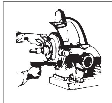
2. Monte el rotor en una maquina para cortar rotores de frenos. Opere el motor de 125 a 210 RPM.
