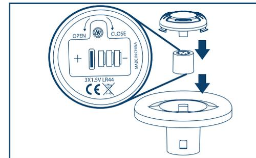
**7.6.- INSTALACIÓN DE LAS BATERÍAS:** Quite el tornillo, después presione la pestaña central y abra la tapa del compartimiento para las baterías.
