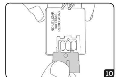
**10.- COLOCACIÓN DE LAS BATERÍAS EN EL MÓDULO ELECTRÓNICO:**
