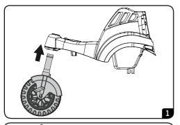
1.- ENSAMBLE DE LA TIJERA: Inserte la tijera en el orificio del chasis
