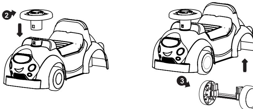
1. Verifique que la parte curva del agujero de la parte superior del poste dirección apunte hacia el frente, enseguida introduzca el poste dirección a través del chasis del montable hasta que salgan las lengüetas que traban el volante en la parte superior del chasis.
