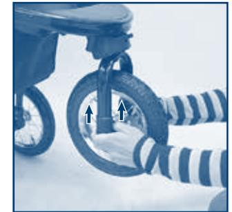
**3.- PARA ENSAMBLAR LA RUEDA DELANTERA:** Retire los bujes plásticos presionando los pernos que se encuentran en la parte interior del tubo al mismo tiempo jalelos hacia afuera, enseguida introduzca el eje de la rueda en el agujero de los bujes, una vez ensamblados introduzca los bujes en los tubos de la tijera, empuje hacia arriba hasta escuchar un "click" que indicará que el ensamble de la rueda ha quedado asegurado.
