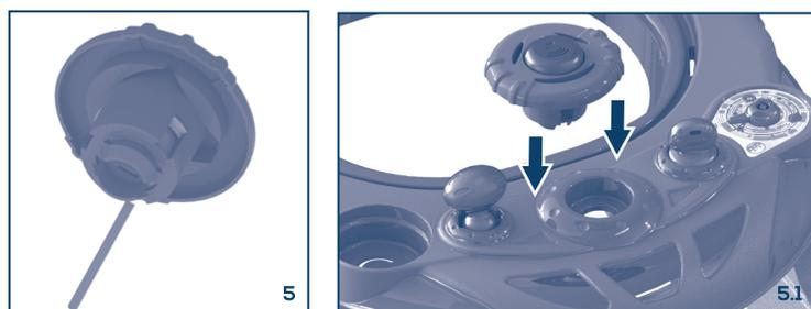
**5.- LENGÜETA DEL MÓDULO ELECTRÓNICO:** Antes de colocar el volante en la charola quite la lengüeta del módulo para que el módulo empiece a funcionar.
