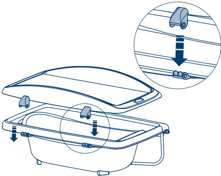
**6.-** Aline los soportes de la tina con los soportes de la tapa, empuje hacia abajo hasta que los pernos de los soportes de la tina entren en los agujeros de los soportes de la tapa y quede ensamblada la bisagra.
