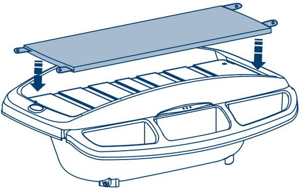
**7.- Colocación de la colchoneta de la tapa:** coloque la colchoneta sobre la tapa, enseguida introduzca una de las lengüetas de la colchoneta en una de las ranuras de la tapa, jale la lengüeta hacia abajo y engánchela en el gancho de la tapa. Repita la operación con las lengüetas restantes.
