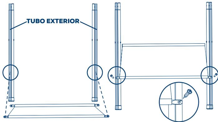
**1.- Ensamble del caballete:** Coloque en el piso los dos juegos de tubo, teniendo cuidado de que las cabezas de los remaches centrales queden hacia el lado exterior.
