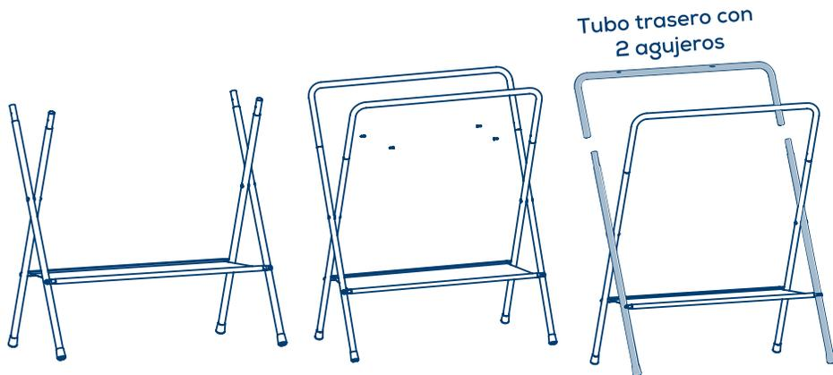
**2.- Ensamble del caballete:** Coloque en forma vertical los tubos y abra el caballete. Enseguida introduzca los tubos superiores en forma de "U", en los tubos del caballete, empújelos hacia abajo hasta hacer coincidir los agujeros del tubo en forma de "u" con los tubos del caballete. Por último introduzca los tornillos autorroscantes para asegurar el ensamble del caballete, repita la operación con el otro tubo.
