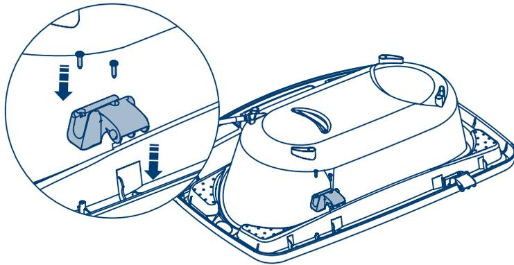
**5.-** Después, coloque los dos soportes de la tina, aliníelos con los cilindros de la tina, inserte los tornillos autorroscantes y apriételes para que los soportes queden asegurados.
