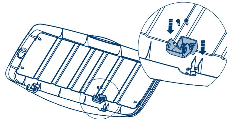
**4.-** Voltee la tapa hacia arriba y coloque los dos soportes, alínelos con los cilindros de la tapa, inserte los tornillos autorroscantes y apriételos para que los soportes queden asegurados.
