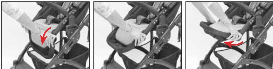
**11.- POSICIONES DEL DESCANSAPIES:** Oprima simultáneamente los botones laterales del descansapiés jale hacia arriba o empuje hacia abajo el descansapiés hasta obtener la posición deseada.
