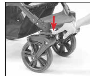
**9.- PARA ACCIONAR LAS LEVAS ANTI GIRO:** Cuando va por caminos irregulares o pedregosos jale hacia arriba las levas anti giro para bloquear las ruedas delanteras (estas no podrán girar hacia los lados facilitando la conducción).
