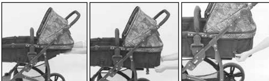
**16. PARA CONVERTIR DE CARRIOLA A BAMBINETO:** Oprima los botones laterales gire el asiento hasta que quede en posición horizontal, después desabroche las hebillas que se encuentran debajo del descansapiés enseguida desabroche las hebillas de la parte trasera del respaldo, por último empuje la vestidura hacia abajo para que se forme el bambineto.
