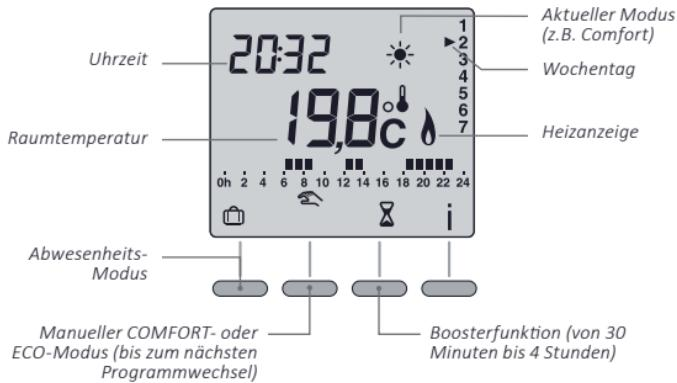
Die Fernsteuerung zeigt die aktuelle Raumtemperatur an (wird durch das Symbol oberhalb von °C angezeigt). Um die eingestellte Temperatur anzuzeigen, drücken Sie die Taste **i**.
