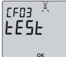
Drehen Sie den Regler zur beliebigen Position um die Erstkonfiguration der Fernsteuerung abzuschließen.
