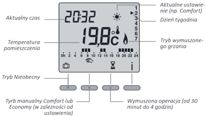
Zgodnie z konfiguracją fabryczną - programator wyświetla temperaturę aktualną pomieszczenia (informuje o tym ikona nad symbolem °C). Aby wyświetlić temperaturę nastawioną, naciśnij klawisz **i**.
