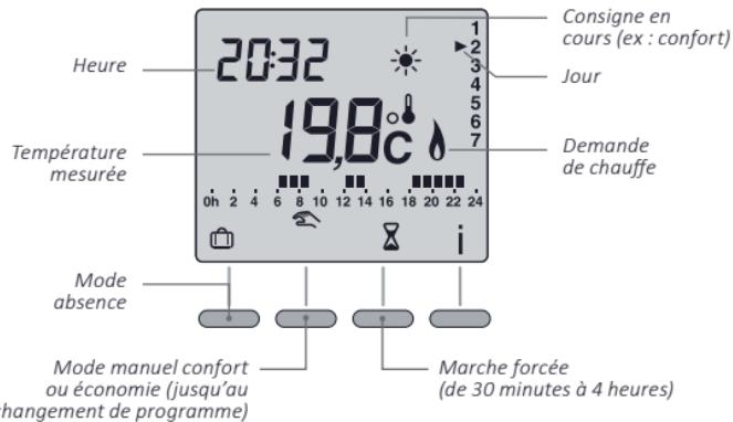
A la mise en service, la température mesurée par le thermostat s'affiche (le symbole s'apprécie au-dessus du °C).
