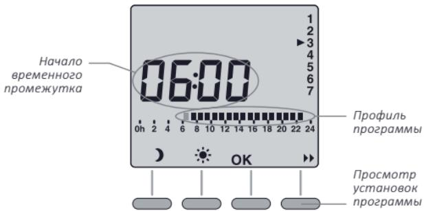
Нажмите OK, чтобы перейти к просмотру установок следующего дня. Чтобы закончить поверните регулятор.
