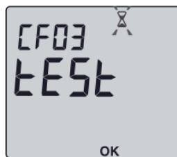
Каждые 3 секунды, программатор посыпает сигнал приемнику посредством инфракрасного модуля. Убедитесь, что приемник реагирует на посыпаемые команды.
