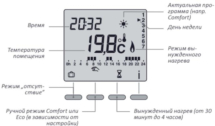
В соответствии с фабричными установками, программатор показывает температуру в помещении (иконка над символом °C). Чтобы просмотреть установленную температуру, нажмите клавишу **i**.
