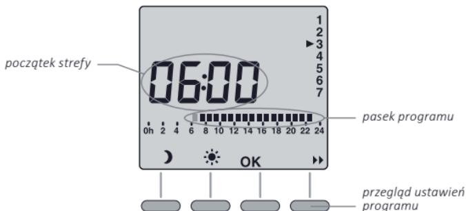
Naciśnij **OK**, aby przejść do przeglądu ustawień kolejnego dnia. Aby zakończyć – zmień pozycję pokrętła.
