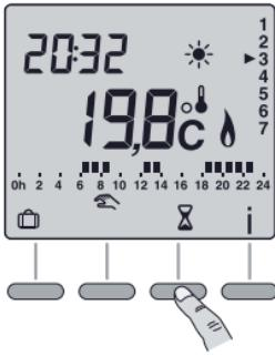
Auf dem Display beginnt die Trockenzeit für die Boosterfunktion zu blinken. Stellen Sie den geplanten Wert mit Hilfe der Tasten + und – ein.
