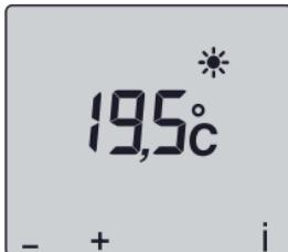
Drücken Sie die Tasten + oder – um den gewünschten Wert einzugeben und drehen anschließend den Regler, um den Vorgang zu beenden.
