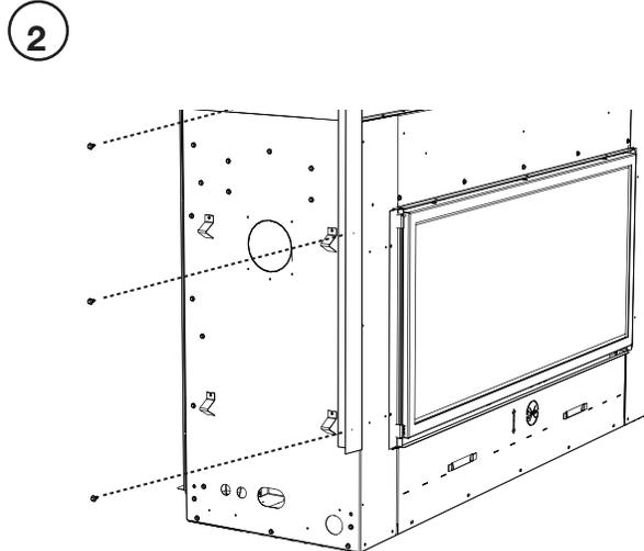
Alignez les pattes de cloutage avec les trous de l'appareil, fixez avec les deux vis d'étape 1.
