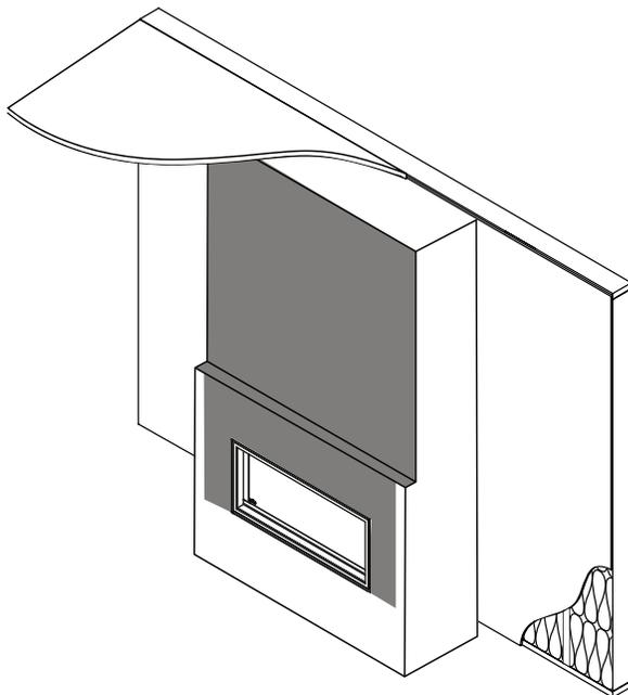
**LA ZONE NON SOMMAIRE DOIT ÊTRE MATÉRI-AUX NON COMBUSTIBLES.** L'installation encastrée **nécessite** un matériau d'évidement pour utiliser un revêtement incombustible en raison de la proximité immédiate de l'évén.
