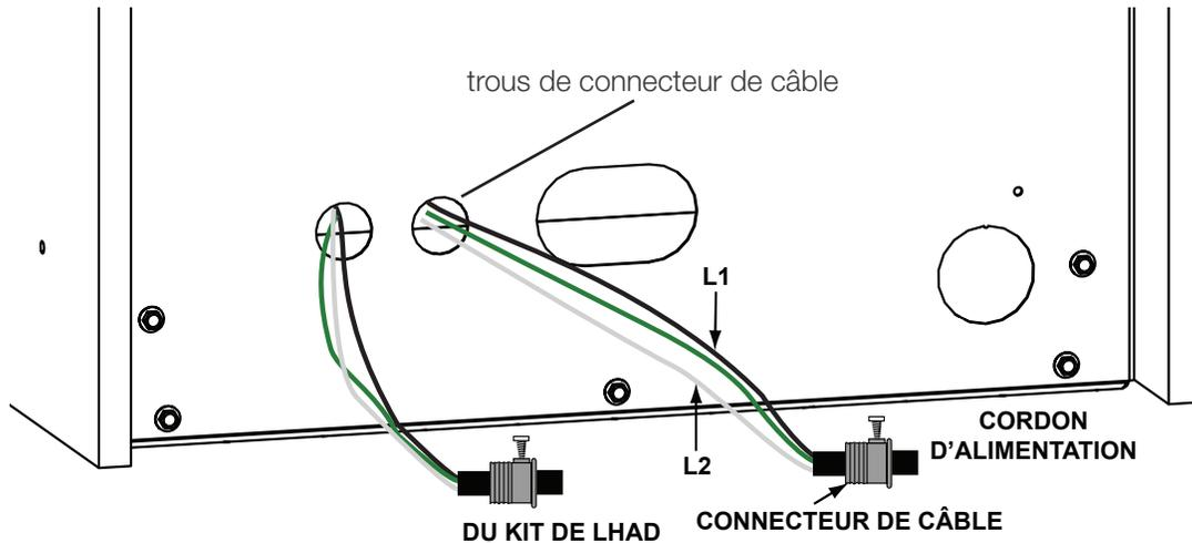
Approchez l'alimentation électrique et le kit LHAD (Linear Hot Air Distribution (c.à.d. distribution linéaire d'air chaud)) en option à travers le foyer extérieur sur la prise montée au bas de l'appareil. Pour l'installation du kit LHAD en option, reportez-vous à la notice fournie dans le kit.
