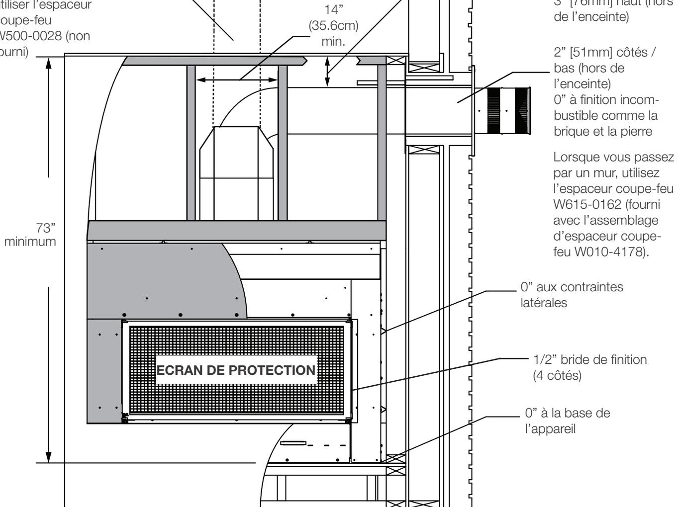
**Sections d'événements horizontales:** Un dégagement minimum aux matériaux combustibles de 3" (76mm) au-dessus hors de l'enceinte et 2" (51mm) sur les côtés et au-dessous hors de l'enceinte toute autour du conduit d'évacuation sur toutes les courses horizontales. Les sections d'évacuation horizontales dans les enceintes doit maintenir un dégagement minimaux de 6" (152mm) au-dessus du conduit d'évacuation.
