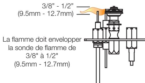
La flamme doit envelopper la sonde de flamme de 3/8" à 1/2" (9.5mm - 12.7mm)
