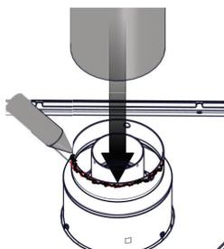
UTILISEZ SILICONE D'HAUTE TEMPÉRATURE POUR SCELLER L'ADAPTATEUR À L'APPAREIL COLLIERS.
