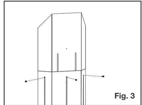
3. Utilisez les attaches à l'étape 1 pour maintenir la nouvelle hauteur de bouclage d'évent (Fig. 3).
