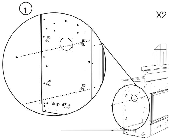
Retirer les deux vis de l'appareil.
