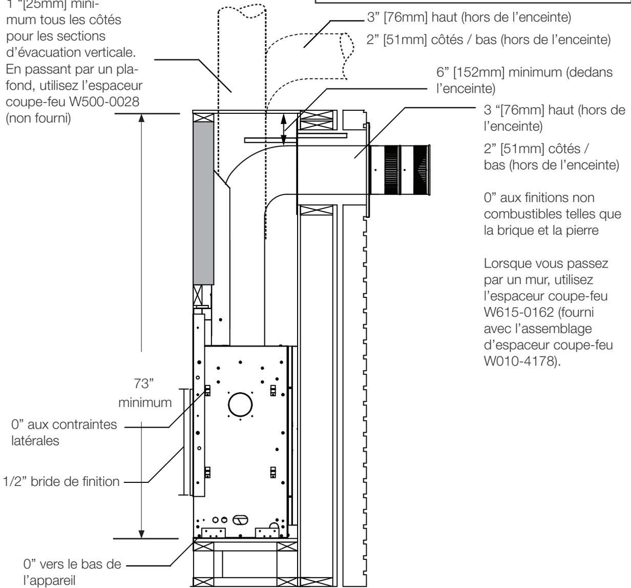
**Sections d'événements horizontales:** Un dégagement minimum aux matériaux combustibles de 3" (76mm) au-dessus hors de l'enceinte et 2" (51mm) sur les côtés et au-dessous hors de l'enceinte toute autour du conduit d'évacuation sur toutes les courses horizontales. Les sections d'évacuation horizontales dans les enceintes doit maintenir un dégagement minimum de 6" (152mm) au-dessus du conduit d'évacuation.
