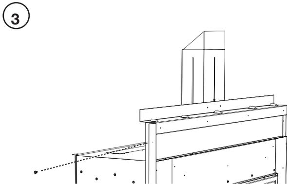
Utilisez les vis fournies pour finir de fixer les pattes de cloutage sur le cadre avant.
