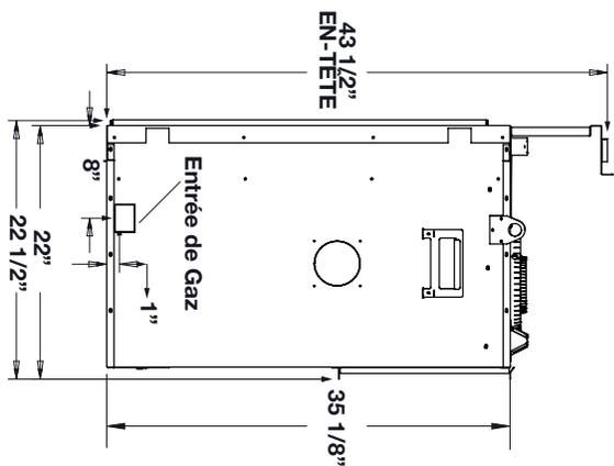
\* La bride de finition (la bride de finition définit le périmètre de l'ouverture de l'appareil. Les matériaux d'ossature ou de finition NE JAMAIS empiété à l'intérieur de la bride de finition).
