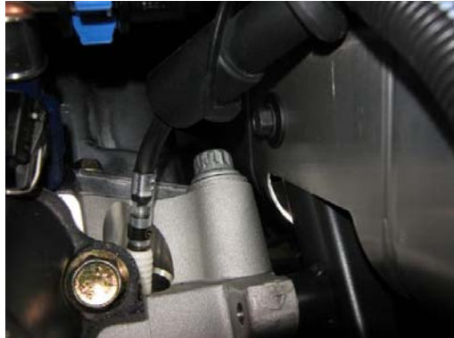
17. Press terminal onto #2 spark plug.
