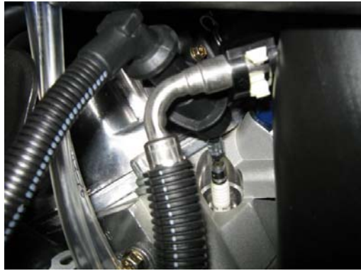
15. Press terminal onto #1 spark plug.
