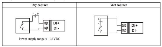
Fig. 3 Dry/Wet contact wiring
