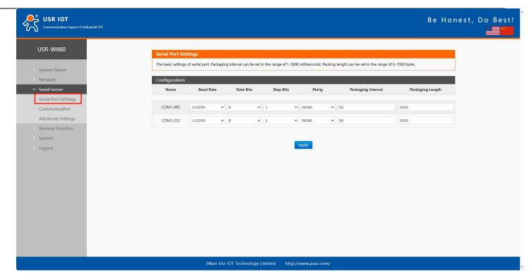
Figure 26. Serial port parameters
