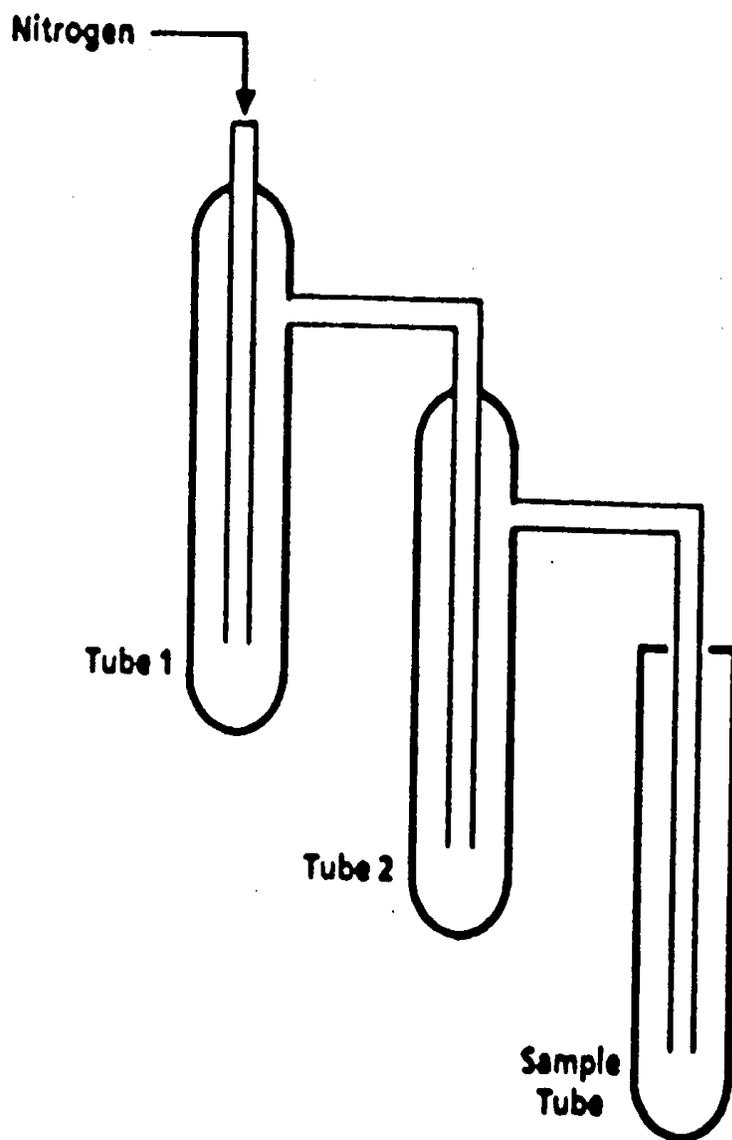
FIGURE 1. GASEOUS DIAZOMETHANE GENERATOR
