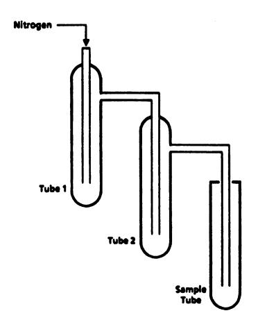
FIGURE 1. GASEOUS DIAZOMETHANE GENERATOR
