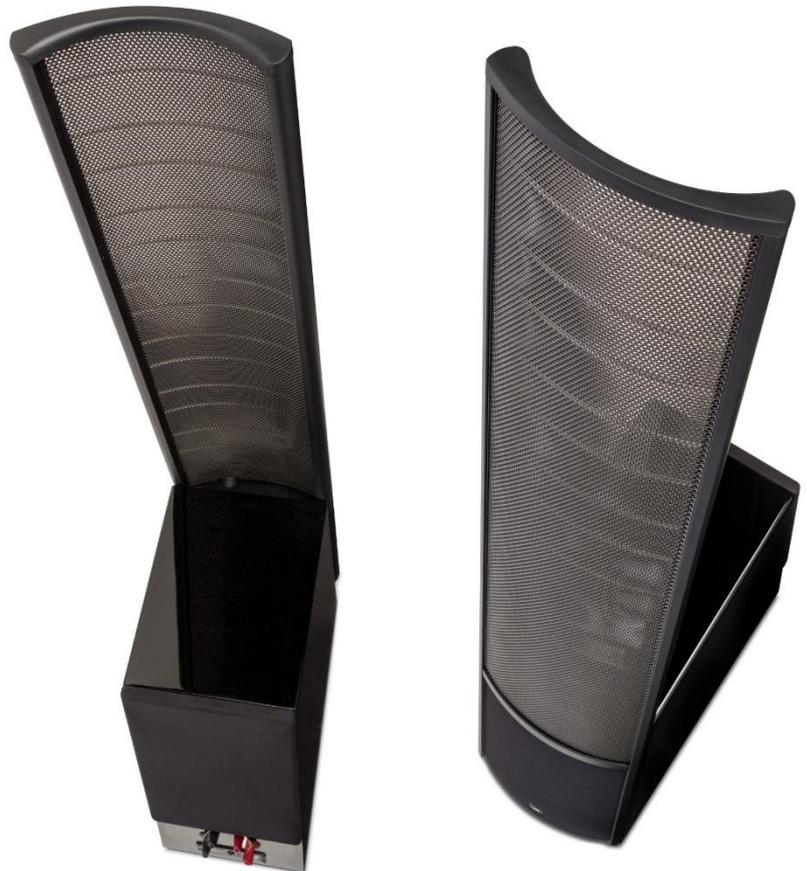
Während der Lautsprecher Musik überträgt, wird die Folie mit einer positiven konstanten Spannung geladen. Das Musiksignal wird an die beiden Statoren mit gleicher Spannung und gegensätzlicher Polarität angelegt. Nun wird die Folie entsprechend dem Musiksignal jeweils von einem Stator angezogen und von dem anderen Stator abgestoßen und überträgt so die Musik.
