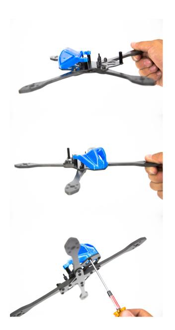
PRESS BACK PART OF POD ONTO FRONT TWO HEXAGONAL STANDOFFS
