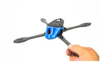
BOLT DOWN THE TOP PLATE TO THE HEXAGONAL STAND-OFFS USING THE 3X8MM BUTTON HEADS.
