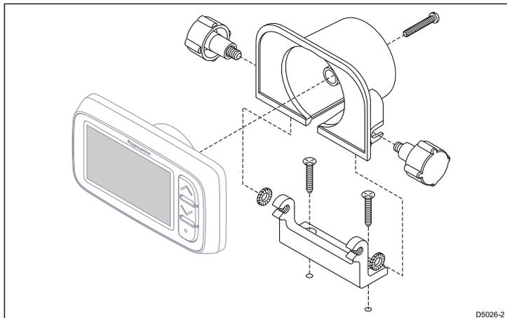
1. 設置面にトラニオン マウントを当て、ネジ穴の位置に印を付けます。
