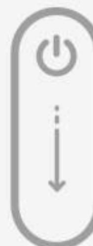
**Poder Encendido / Apagado** - Toque y deslice de arriba hacia abajo, la primera vez que se encienda. Y una vez más para apagar.
