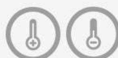
Dans le même temps, touchez la "température + température - ", commutateur degrés Co ou F (Degrés Celsius ou Fahrenheit).
