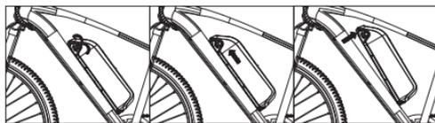
1. Tournez la clé dans le sens des aiguilles d'une montre pour verrouiller la batterie. Tournez la clé dans le sens antihoraire pour ouvrir le verrou de la batterie.
