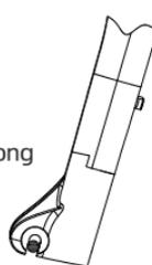
2. Pour fixer la roue avant, tournez manuellement les écrous d'ancrage dans le sens des aiguilles d'une montre. Assurez-vous que la roue avant est située au centre même de la fourche avant et que le rotor de frein à disque est parallèle à l'étrier de frein à disque vers l'extrémité de la fourche avant avec un espace entre les deux. Gardez un peu d'espace des deux côtés et serrez avec une clé comme indiqué ci-dessous :
