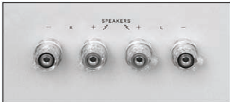
Abb. 2 Lautsprecherklemmen am Verstärker (Beispiel).
