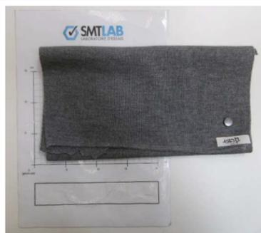
**~NF EN ISO 12945-2 10-2000 Détermination de la propension à l'ébouriffage et au boulochage
