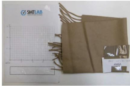
**~NF EN ISO 12945-2 10-2000 Détermination de la propension à l'ébouriffage et au boulochage
