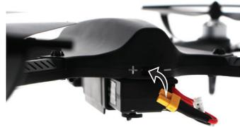
INSERT POWER PLUG INTO POWER SOCKET
