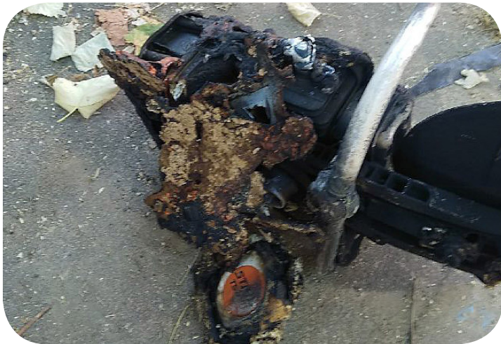
Conséquence d'un remplissage à chaud sans bec verseur
