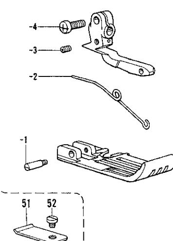
D. 押工関係/Presser foot mechanism/Stoffdrückerfuß/
