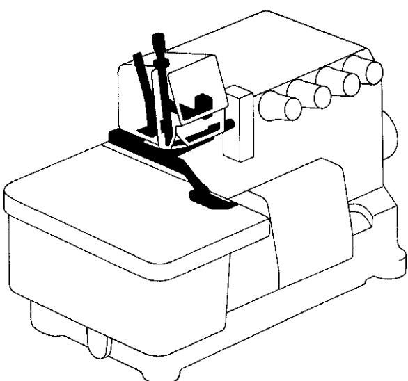
D. 押工関係/Presser foot mechanism/Stoffdrückerfuß/
