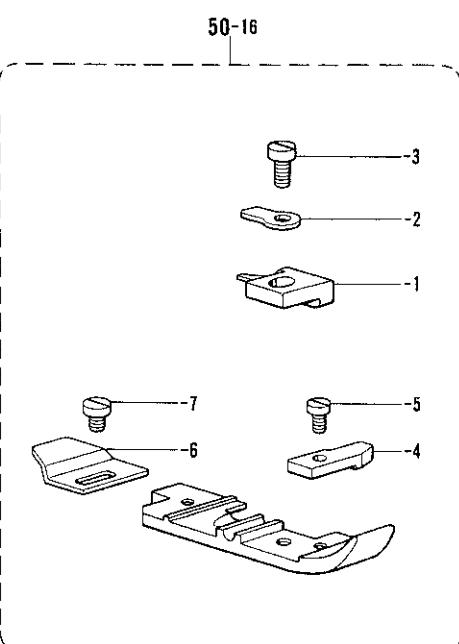
D. 押工関係/Presser foot mechanism/Stoffdrückerfuß/
