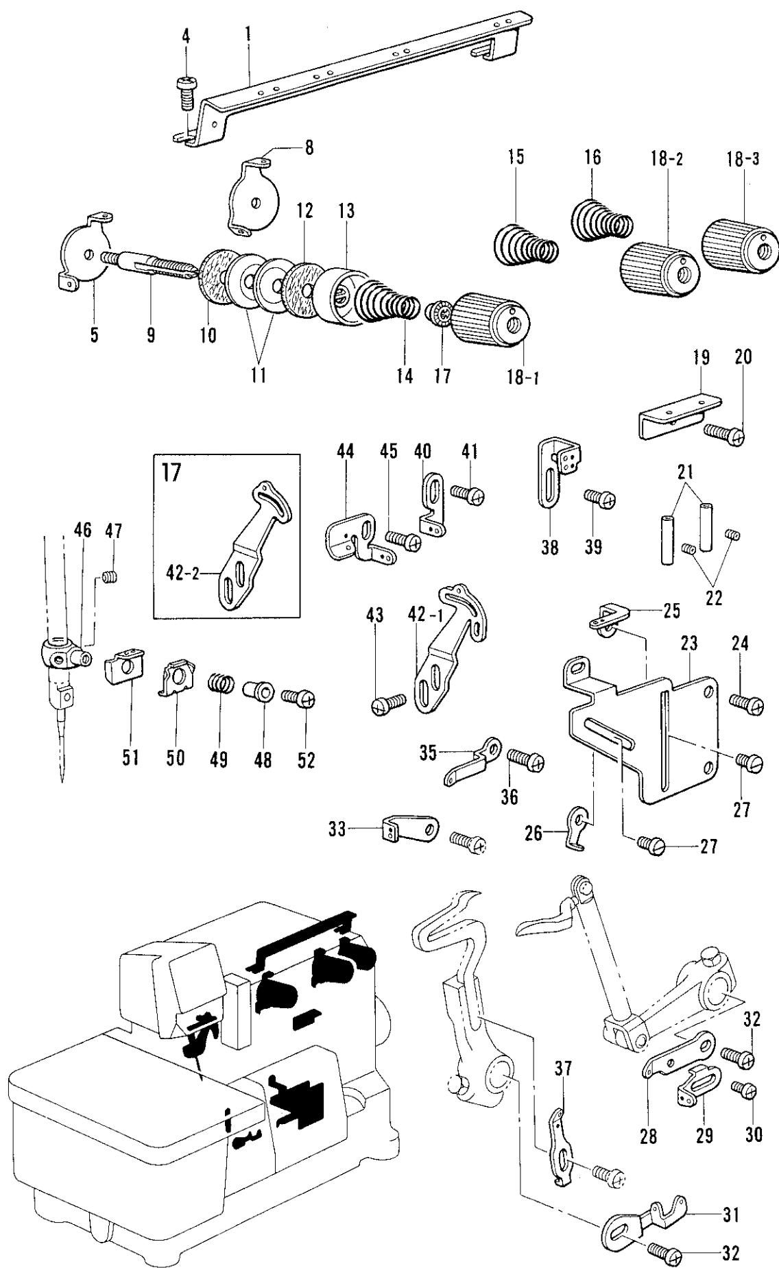
K. 糸調子関係 / Thread tension/Faderspannung/
