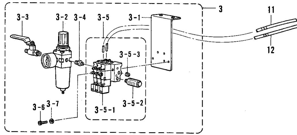
P. 空圧関係 / Air pressure mechanism / Luftdruck / Mécanisme de la pression d'air / Mecanismo de la presión de aire
