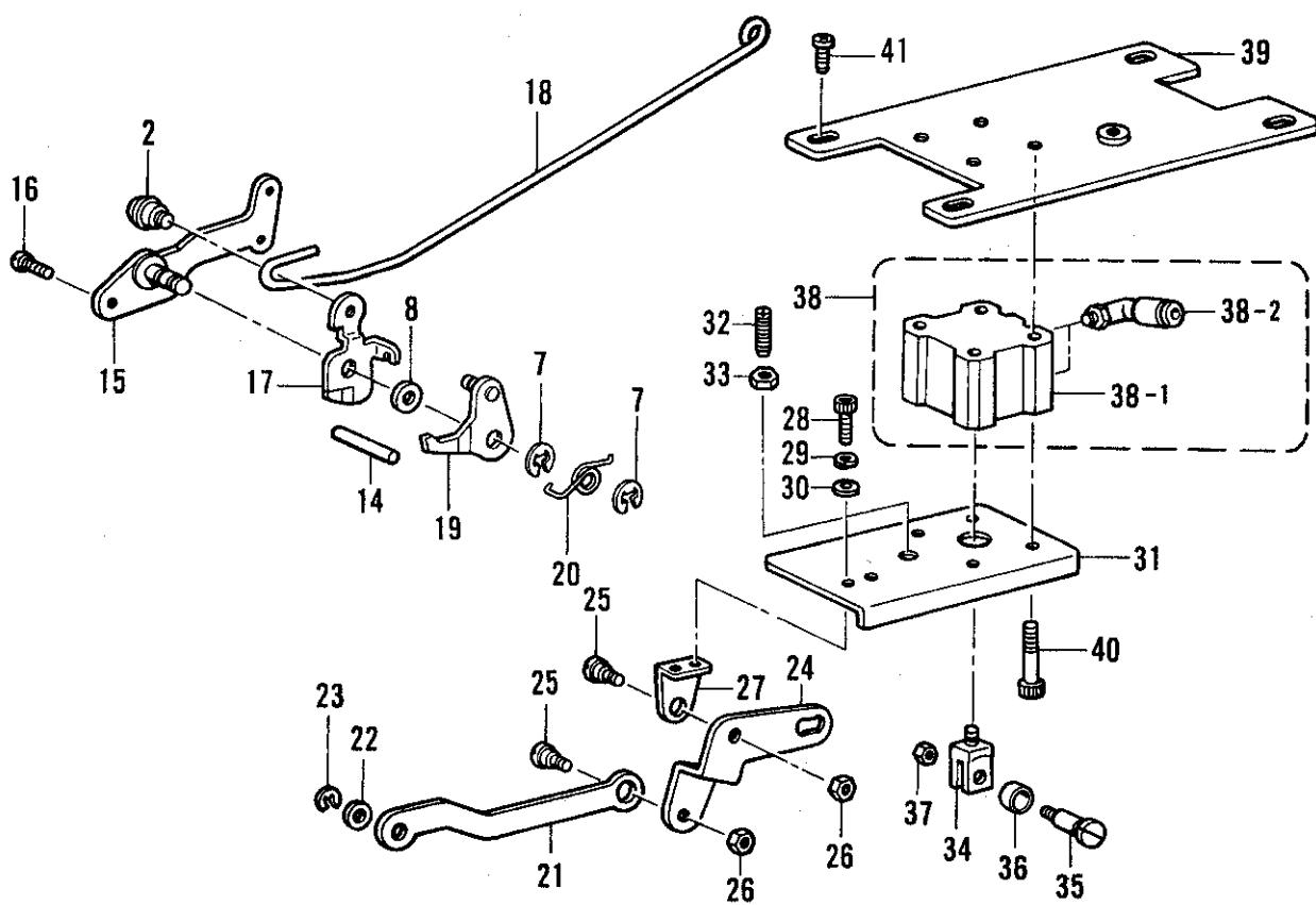
L. 糸締メ関係 / Thread nipper mechanism / Fadenspannvorrichtung / Mécanisme de pince-fil / Mecanismo de la mordaza para hilo
