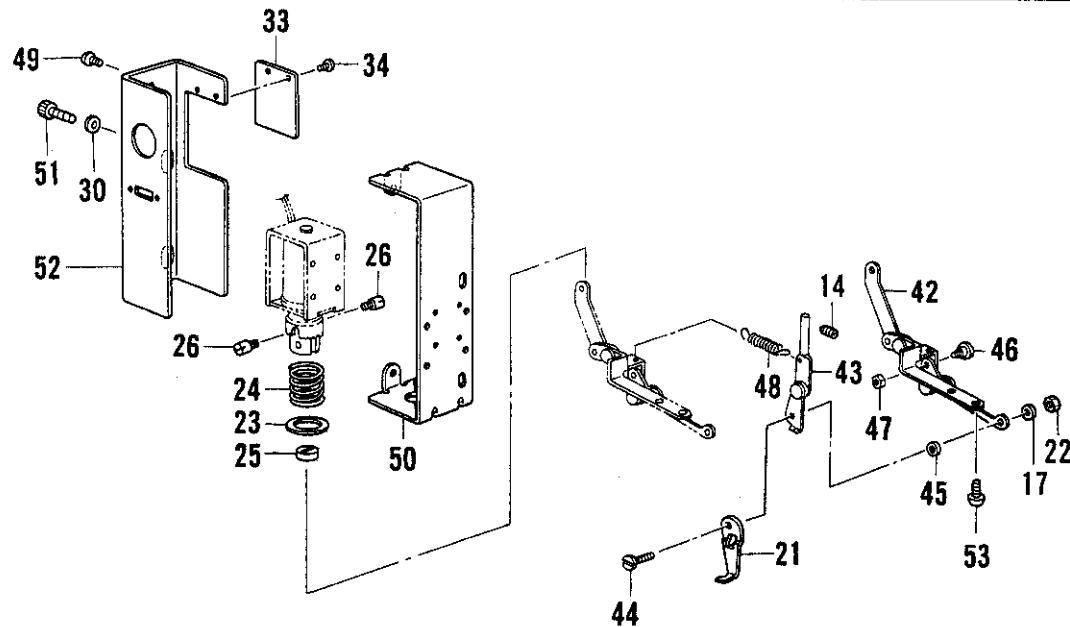
K. 糸扱い関係 / Thread wiper mechanism / Fadenwischvorrichtung / Mécanisme de tire-fil /
