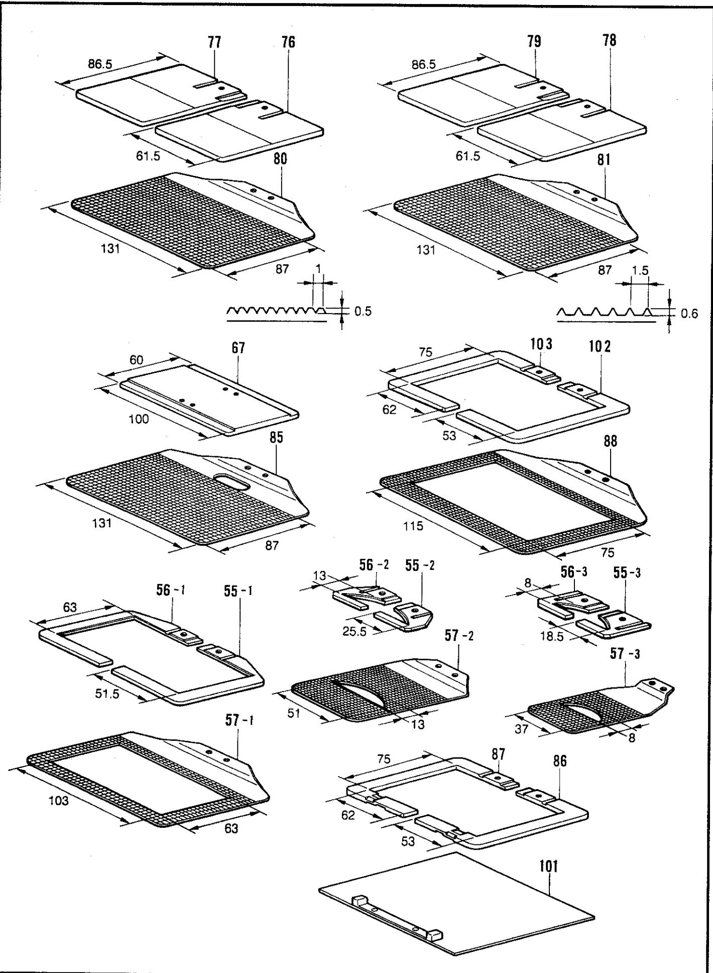
C5. 送り関係 / Feed mechanism / Transportvorrichtung / Mécanisme de l'entraînement /
