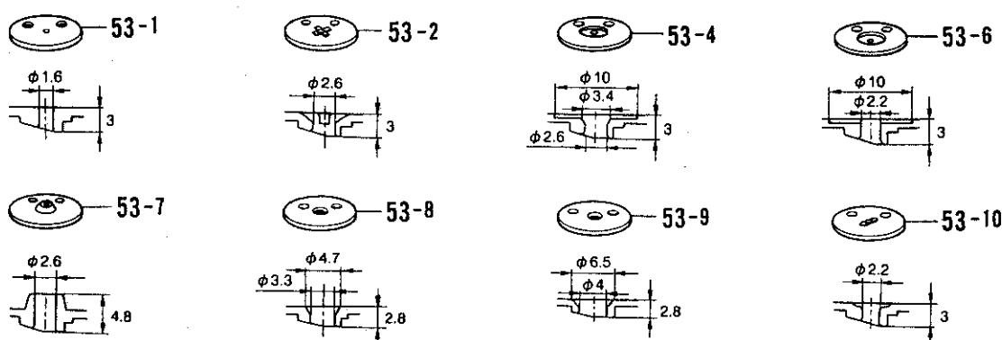
J. 糸切り関係 / Thread trimmer mechanism / Fadenabschneidevorrichtung / Mécanisme de coupe-fil / Mecanismo de la cortadura de hilos
