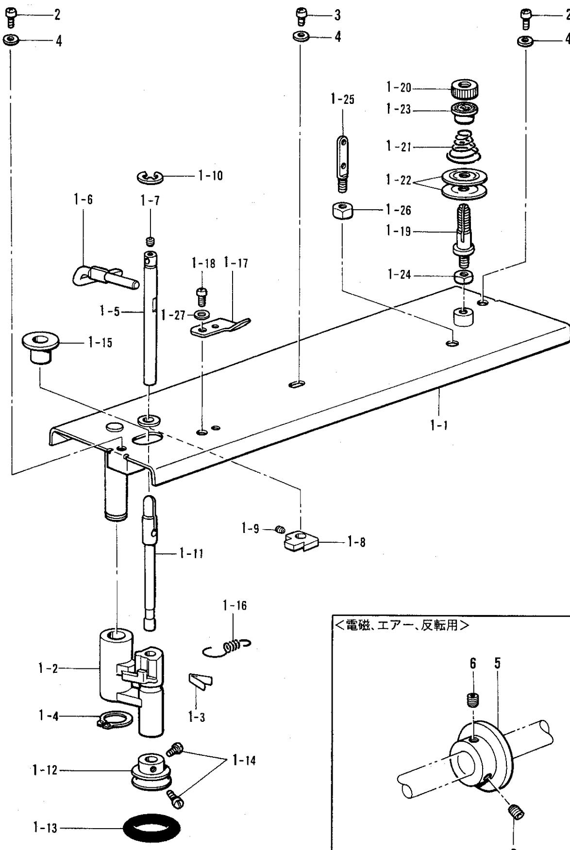
H. 糸巻関係 / Bobbin winder mechanism / Spuler / Mécanisme du bobineur / Mecanismo del devanador de la canilla
