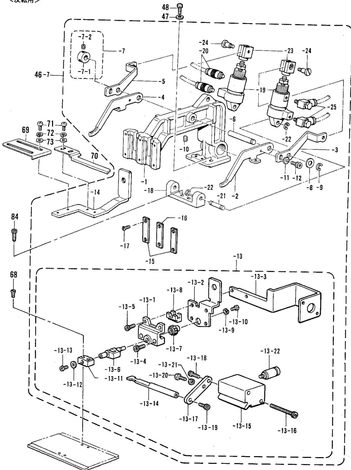
C4. 送り関係 / Feed mechanism / Transportvorrichtung / Mécanisme de l'entraînement /
