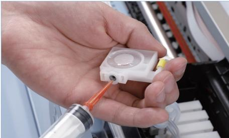
4 Insérer une seringue d'encre vide dans le trou de remplissage de la cartouche
