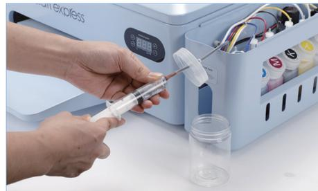
3 Fixer l'extrémité de la conduite à la seringue et tirer lentement sur le piston jusqu'à ce que l'encre y pénètre
