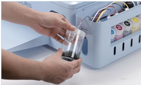
4 Replacer la conduite d'encre usée dans le réservoir et visser le cache
