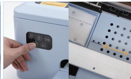
3 Appuyer sur le bouton  $\nabla$  et tirer le film jusqu'à l'emplacement indiqué
