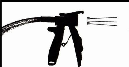
Tourner la valve de l'adaptateur sur position ouverte. Appuyer sur la gâchette et le tuyau sera automatiquement rempli. Continuer jusqu'à ce que toute la substance (blanche) soit sortie du tuyau.
