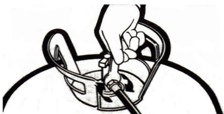
1° À l'aide de la clé, serrez les raccords entre les tuyaux et les vannes des bonbonnes, pour « A » et pour « B ». La clé a été conçue pour se tordre en cas de pression trop forte.
