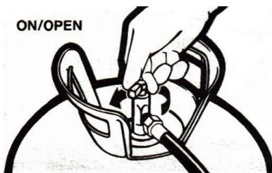
3° Ouvrez complètement les vannes des bonbonnes, en vérifiant le bon écoulement du produit à travers les tuyaux.
