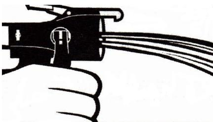
4° Actionnez le pistolet sans buse au dessus d'un sac en appuyant sur la gâchette du pistolet **INSTA-FLO™**. Quand les 2 jets sont de forces identiques, relâchez la gâchette, nettoyez le produit sur le pistolet avec le spray d'acétone et appliquez à nouveau de la vaseline.
