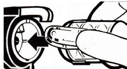
5° Choisissez votre buse, insérez-la et poussez-la fermement sur la partie avant du pistolet **INSTA-FLO™**, jusqu'à entendre un clic. Vérifiez ensuite que la buse est bien insérée.
