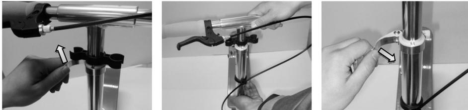
8. Чтобы отрегулировать высоту рукояток, откройте рычаг быстрого зажима.
