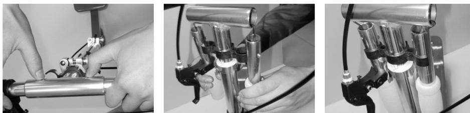
1. Складывание рукояток: Нажимая на кнопки пружин на рукоятках, вытяните рукоятки из трубы Т-вида.
